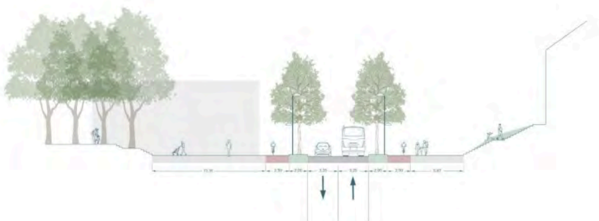
pav.6. Siūlomas A. Vienuolio g. (ties tilto pabaiga) profilis pagal Anykščių miesto darnaus judumo planą
